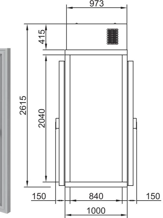
4. Камеры без пола с двумя дверными блоками. Выполняются в среднетемпературном режиме.
