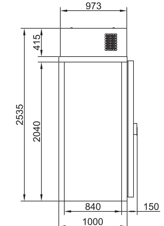
2. Камеры с полом и двумя дверными блоками. Выполняются как в среднетемпературном, так и в низкотемпературном режимах.
